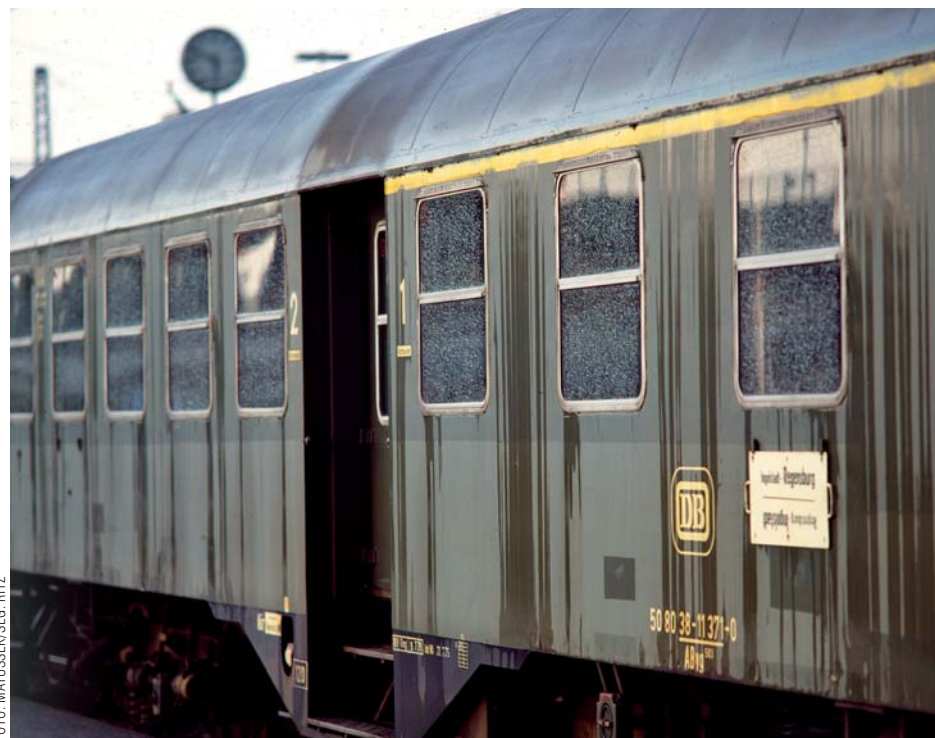
In den frühen 1980er-Jahren hatten die Umbauwagen wie dieser AB4y in Ingolstadt ihre beste Zeit schon hinter sich. Der Rost nagt schon zwischen Wagenkasten und Dach.
