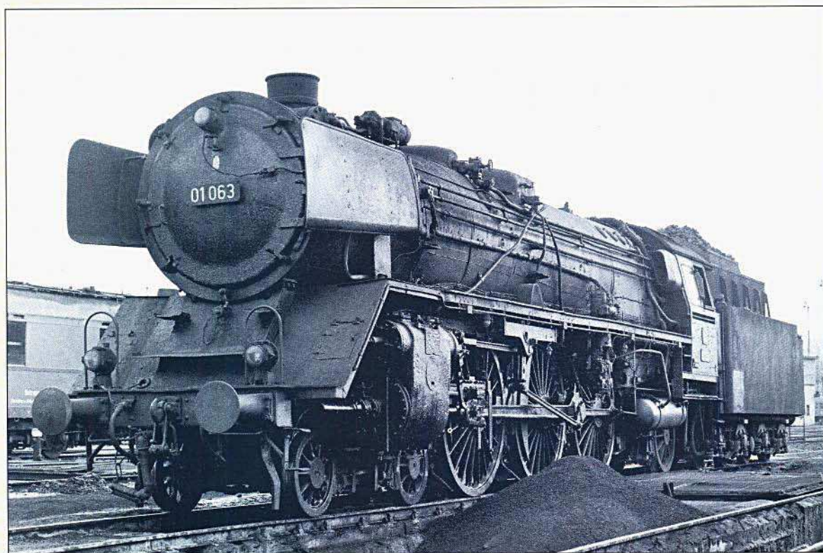
Bild 7: 01 063 mit Altbaukessel, Witte-Blechen und Pumpen in Fahrzeugmitte.
