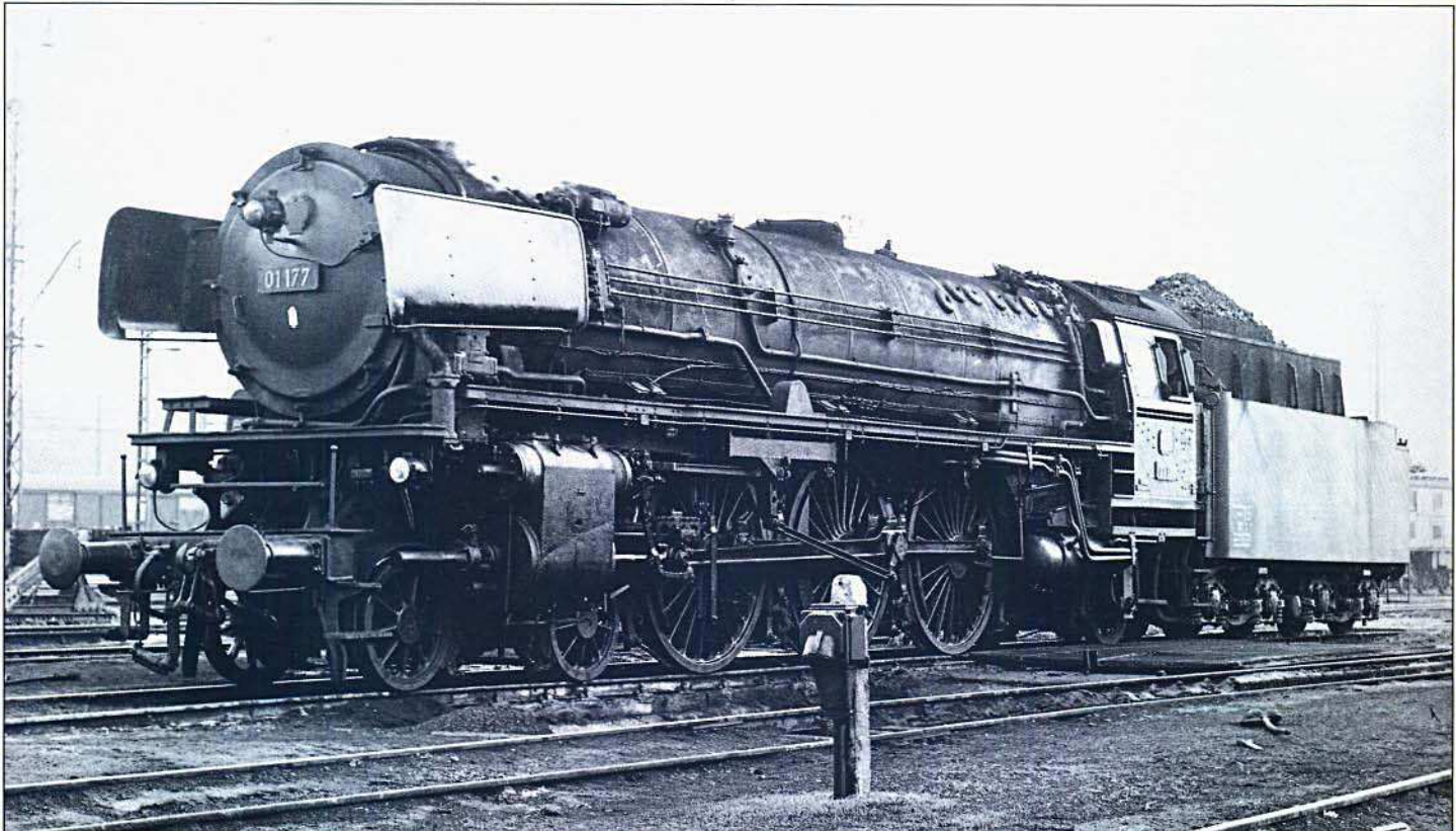
Bild 11: 01 177 mit DB-Neubaukessel und Ersatzzylindern. Abb.: H. Obermayer
