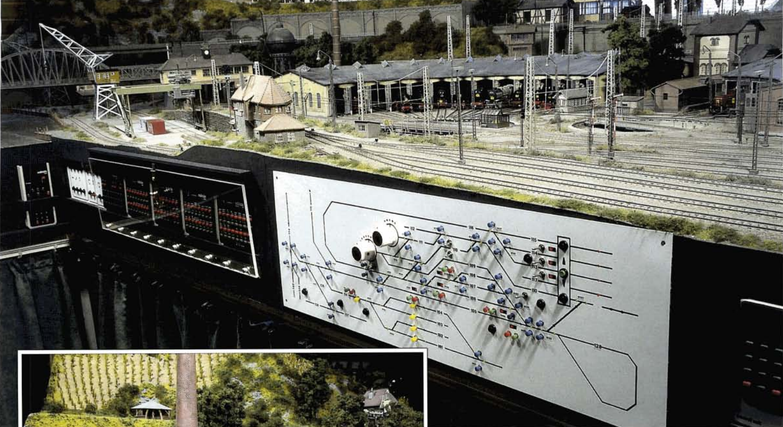
Bild 4: Die Ansteuerung der gewaltigen Anlage erforderte trotz digitaler Technik ein sehr komplexes und wohl durchdachtes Stellpult.
